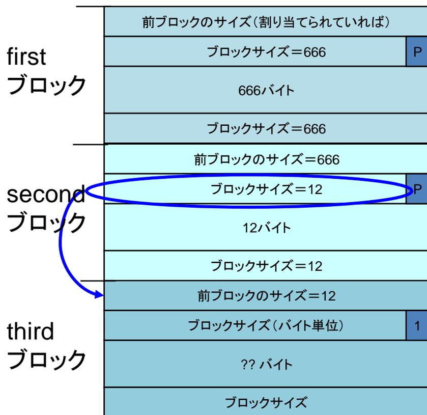
dlmalloc は、size フィールドを使用して、隣接する次ブロックのアドレスを算出する。
