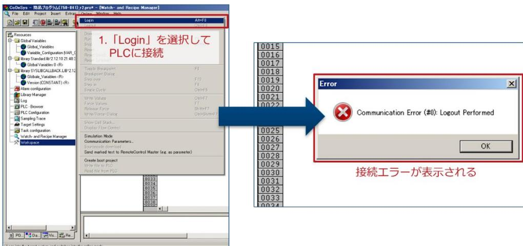
[図 10 : 細工したパケットを送信後の CODESYS v2.3 から WAGO 750-841 への再接続]
