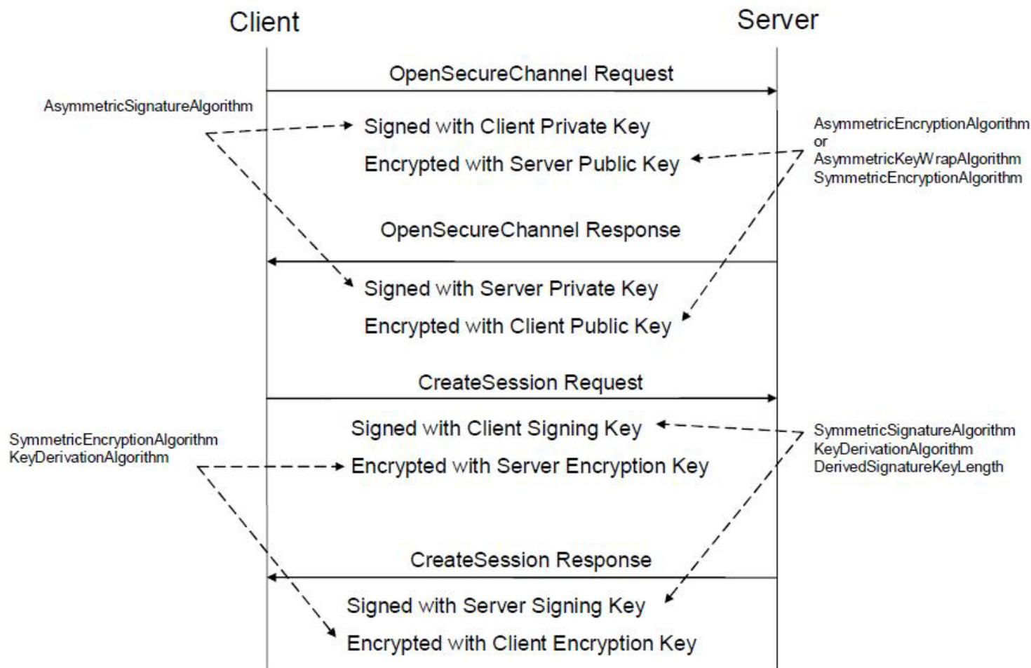
OpenSecureChannelによるセッション確立時は非対称方式で鍵共有を確立。
