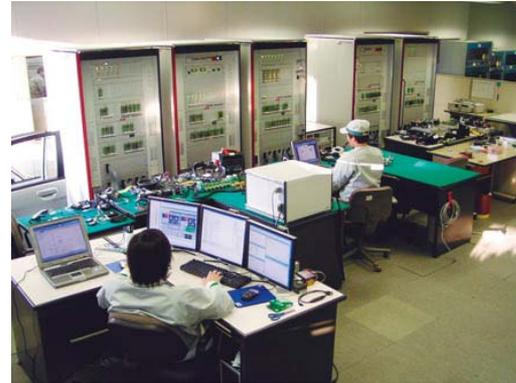
2007年秋、三菱自動車は、同社としては初めて「フルビークルHILS」を車両開発に適用した車種「ギャラン フォルティス」「ランサーエボリューションX」を発売する(1)(扉参照)。フルビークルHILSは、ネットワークでつないだ車両1台分のECU数十台を一度に評価できるHILSで、日本の完成車メーカーがフルビークルHILSの量産車への適用を明らかにするのは初めてだ(図)。欧州では、すでにDaimler Chrysler 社が「Mercedes-Benz AClass」や「同C-Class」への適用を明らかにしているほか、フランスRenault 社も車両1台分を評価できるフルビークルHILSの設備を備えているという。
